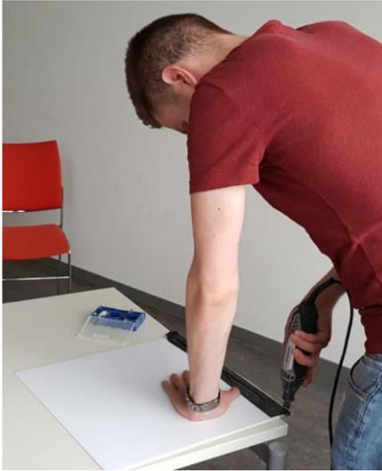
**Abbildung 3: Platte abschleifen**
