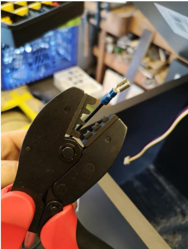
Abbildung 13: Presszange und Verkleidung des Kabels mit Metallschuh
