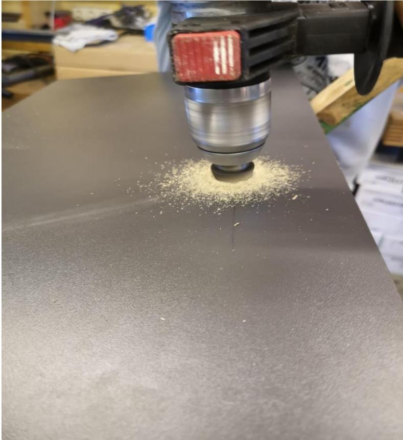
*Abbildung 8: Kegelbohrer für Loch des Touchbuttons*
